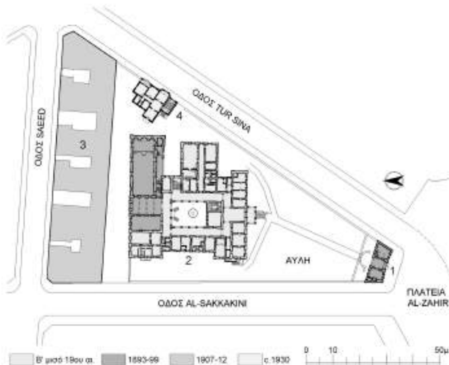
Εικ. 3. Κάιρο. Τοπογραφικό διάγραμμα Σιναϊτικού Μετοχίου. 1. Πρόπυλο (1893-9), 2. Κεντρικό κτήριο (β' μισό 19 ου αι., 1893-14), 3. Τριώροφη πολυκατοικία (1907-8), 4. Διώροφη κατοικία με καταστήματα στο ισόγειο (περί το 1930) (σχέδιο: Π. Κουφόπουλος, Μ. Μυριανθέως, Στ. Παρασκευόπουλος).
