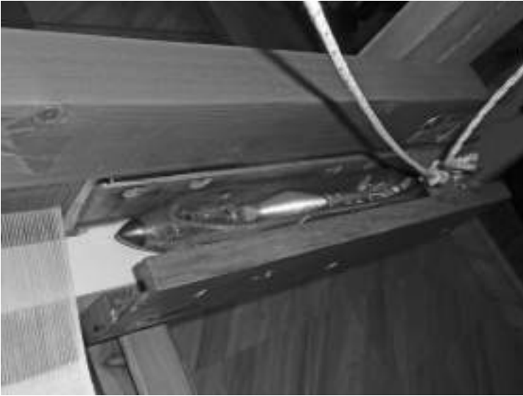
Εικ. 5. Ιπτάμενη ή πεταχτή σαΐτα με κορδόνι και μεταξωτό υφάδι, τυλιγμένο στο καρούλι της. Μονή Αγίας Ειρήνης Ρεθύμνου (φωτ. Ελ. Βλαχοπούλου, Νοέμβριος 2018)
