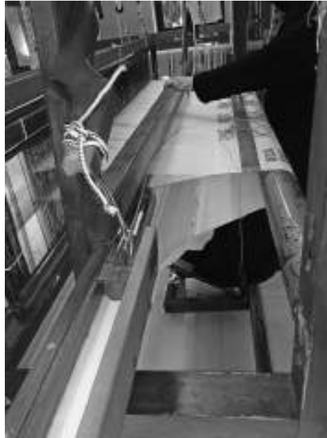
Εικ. 7. Υφαίνοντας πολυσταύριο τριοπατήτηρο. Εμπρός αντί για το τύλιγμα του υφασμένου υφάσματος, σαΐτα, οξίγλα, χτένι, πατήθρες. Μονή Αγίας Ειρήνης Ρεθύμνου (φωτ. Ελ. Βλαχοπούλου Νοέμβριος 2018)
